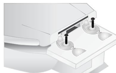
B) introduzca el tornillo en el barreno de la cerámica y coloque la rondana y la tuerca.
